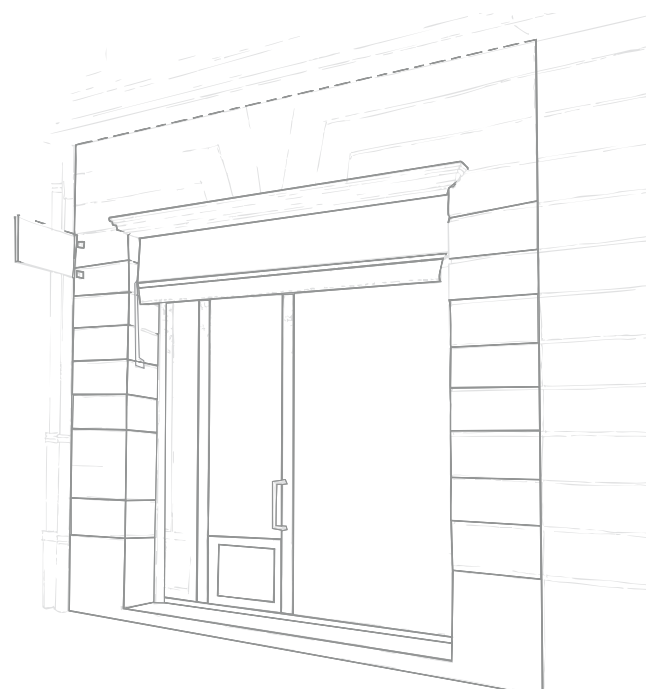
Exemple de devanture en feuillure
