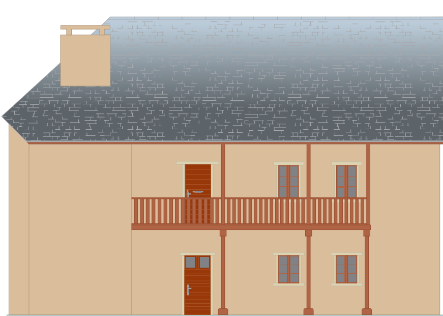
Galerie sur poteaux bois reposant sur des socles en pierre
